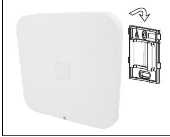
Şekil 11. Baz İstasyonunun Montajı.
